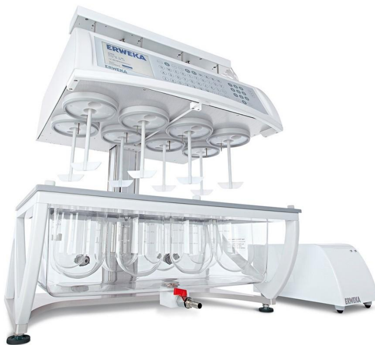
Рисунок 17 – Тестер высвобождения типа аппарат «Корзинка» от компании Erweka
