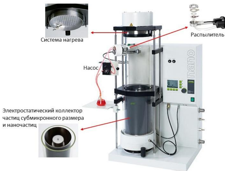
Рисунок 6 – Схема распылительной суши Buchi Nano Spray Dryer B-90
