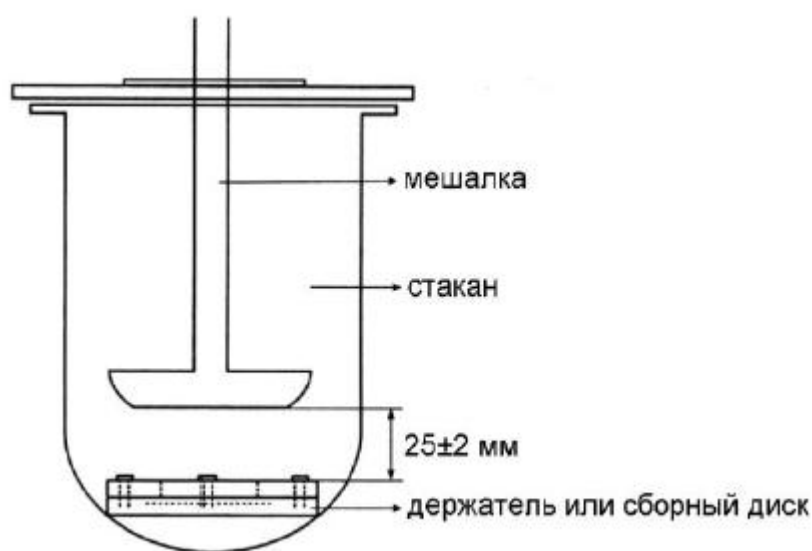
Рисунок 18 – Схема корзинки для растворения системы доставки
