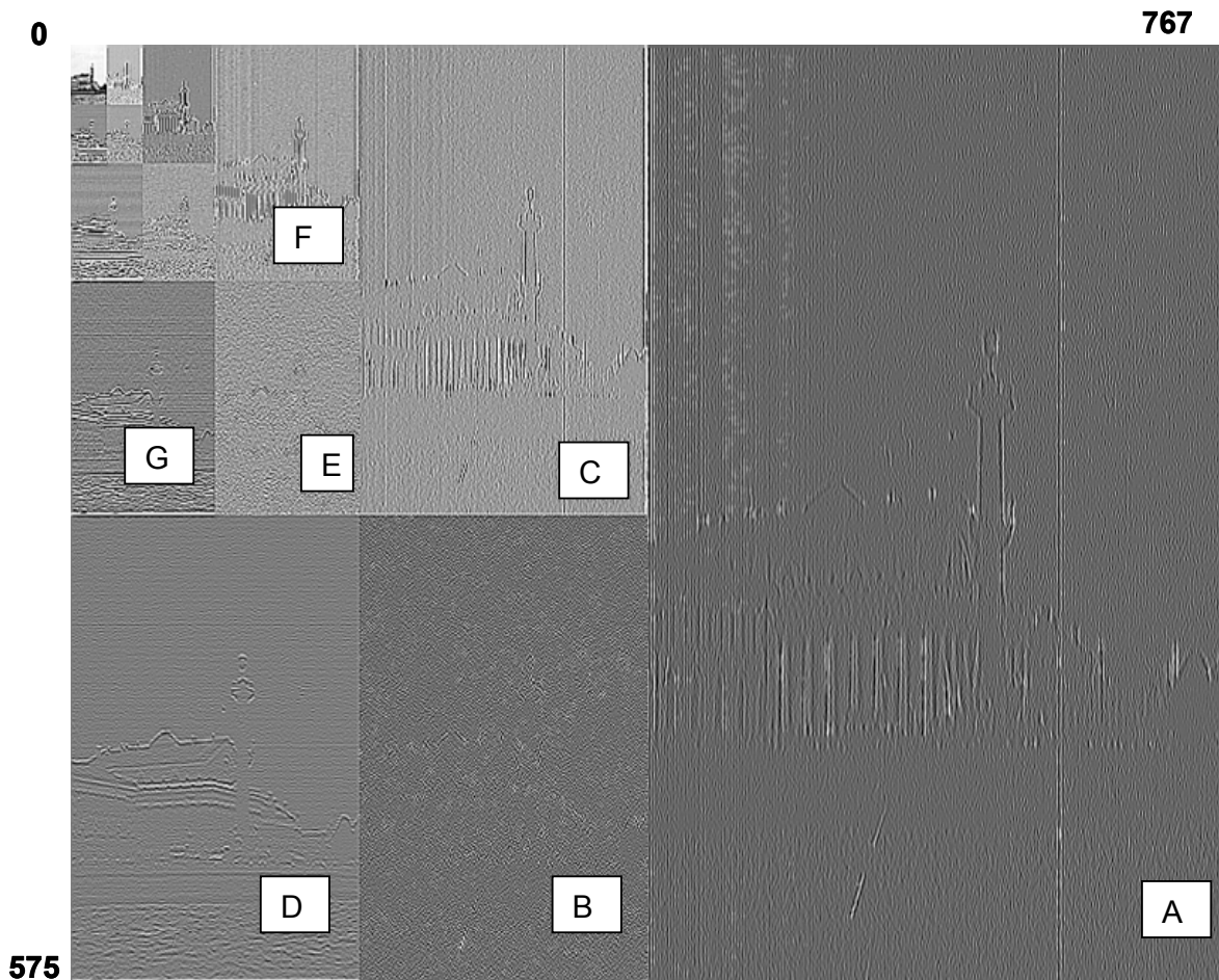
Рисунок 8.17 Пространственное расположение блоков коэффициентов в кадре изображения после вейвлетного преобразования.
