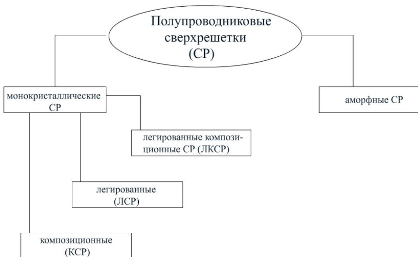
Полупроводниковые материалы, полупроводники, применяемые для изготовления электронных приборов и устройств. В полупроводниковой электронике используют главным образом кристаллические П. м. Большинство из них имеет кристаллическую структуру с тетраэдрической координацией атомов, характерной для структуры алмаза.
