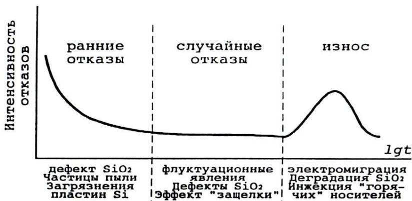
Рис.6.4. Интенсивность отказов ИС
