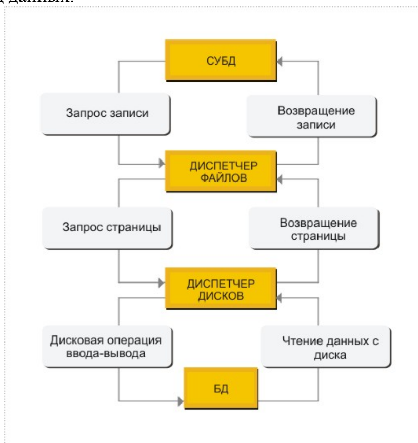
Рис. 7.1. Схема доступа к базе данных
