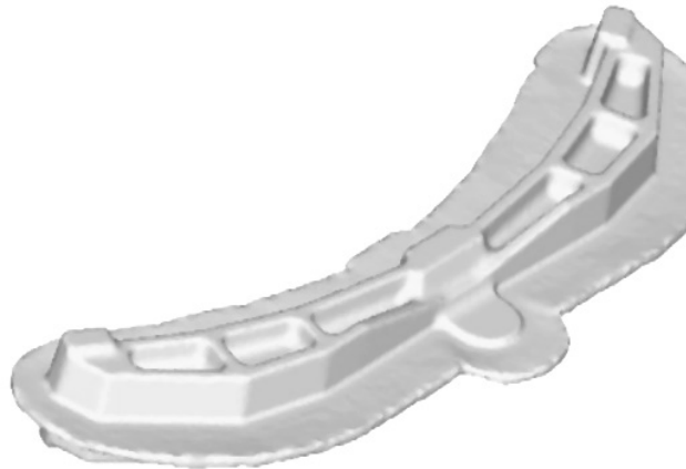
Рис. 2.21. Компьютерное моделирование процесса горячей штамповки в DEFORM 3D: а, б, в – предварительные операции; г – окончательная штамповка
