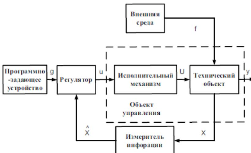
Рисунок 1 - Обобщенная функциональная схема системы управления.
