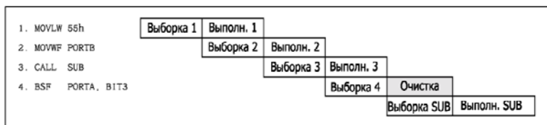
рис.100. Выборка и выполнение команд в конвейерном режиме
